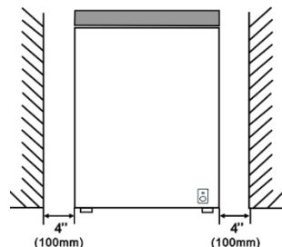
S'il est installé à côté d'une source de chaleur ou d'un réfrigérateur, respectez les dégagements latéraux minimums suivants :
