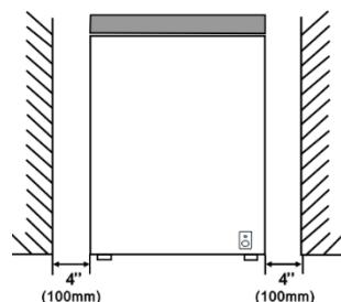
Se installato accanto a una fonte di calore o a un frigorifero, mantenere le seguenti distanze minime laterali:
