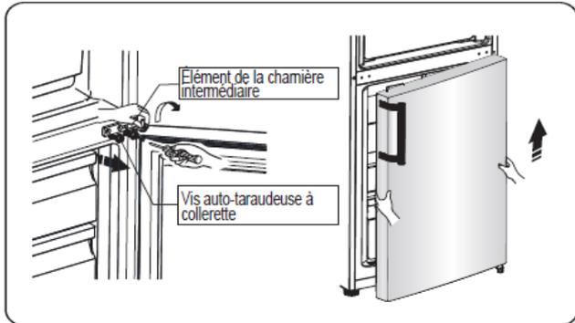
8. Placez la porte supérieure sur une surface souple, le panneau faisant face au plafond. Desserrez la vis ② et l'élément ①, puis installez-les du côté gauche, et serrez fermement.
