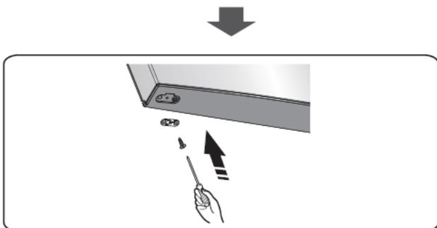
9. Changez le positionnement du cache du trou de la vis (sur la plaque de recouvrement intermédiaire) en le faisant passer de gauche à droite (comme sur l'illustration suivante).
