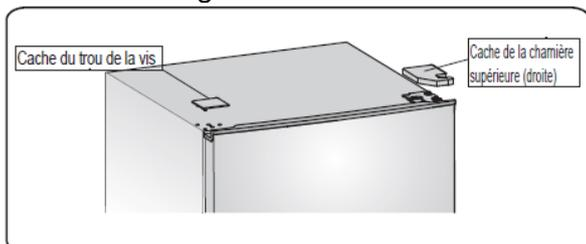
3. Dévissez les vis auto-taraudeuse à collerette, utilisées pour fixer l'élément droit de la charnière, en utilisant une douille 8mm ou une clé à douille (veuillez maintenir la porte supérieure de votre main pendant cette opération).
