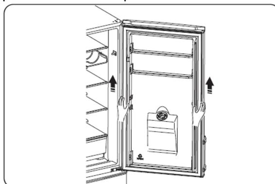
6. Placez la porte supérieure sur une surface souple, le panneau faisant face au plafond. Desserrez la vis ② et l'élément ①, puis installez-les du côté gauche, et serrez fermement.
