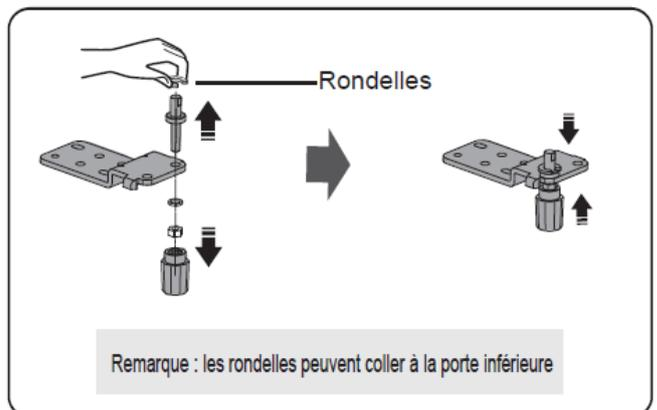
12. Remettez en place l'élément de la charnière inférieure du côté gauche, et fixez-le au moyen des vis auto taraudeuses à collerette. Remettez en place le pied-planche avant du côté gauche, et fixez-le au moyen des vis auto taraudeuses à collerette. Installez les éléments des pieds-planche ajustables.
