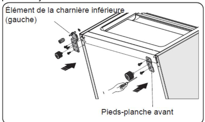
13. Déplacez la porte inférieure sur sa position d'origine, ajustez l'élément de la charnière inférieure, placez l'axe charnière dans le trou inférieur de la porte intérieure, puis serrez les boulons.
