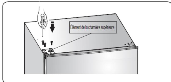
17. Installez le cache de la vis sur le côté droit du réfrigérateur. Installez le cache de la charnière supérieure (fourni dans le sachet), côté gauche. Placez l'autre cache supérieur dans le sachet plastique.
