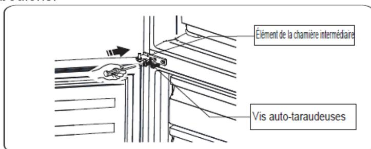
15. Déplacez la porte supérieure à l'emplacement adapté. Sécurisez le niveau de la porte, placez l'axe charnière sur le trou inférieur de la porte supérieure.
