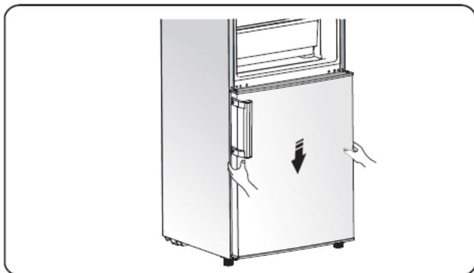
14. Faites tourner la charnière intermédiaire à 180°, déplacez-la dans sa position, en veillant à ce que l'axe charnière se situe sur le trou supérieur de la porte inférieure, puis serrez les boulons.
